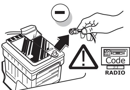
(DE) Um Störungen und Schäden am Bordnetz zu vermeiden, muss die Massepolklemme unbedingt vor Beginn aller Arbeiten von der Fahrzeughilfsbatterie getrennt werden! Insbesondere bei Arbeiten und Anschlüssen am CAN-Datenbus kann bei nicht abgeklemmter Batterie sowohl das Anhängermodul als auch das fahrzeuseigene Bordnetzsteuergerät beschädigt werden! Bitte Herstellervorschriften beim Ab- und Anklemmen der Fahrzeughilfsbatterie beachten!
