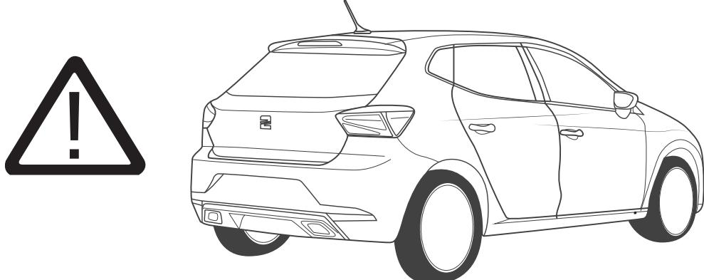
Bitte beachten Sie, dass die Bedienung der elektrischen Heckklappe auch bei angeschlossenem Fahrradträger/Anhänger/Wohnwagen weiterhin funktioniert. Sie muss manuell bedient werden.
